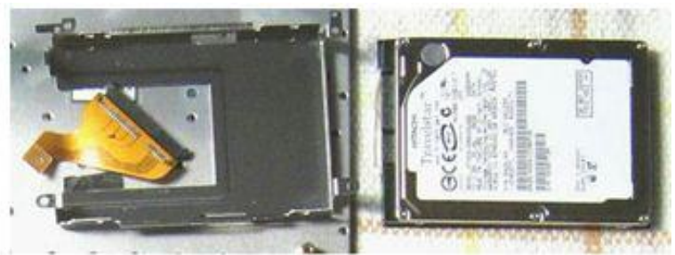
ケースからハードディスクを外したところ (簡単なケースに4本の皿ビスで固定されている。)
